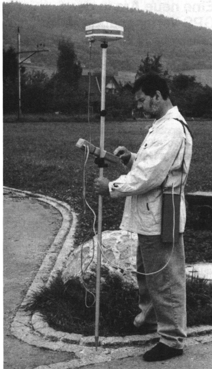
Abb. 1: Beispiel für Aufstellung mit Lotstock, für «Stop and Go» (mobiler Empfänger).
