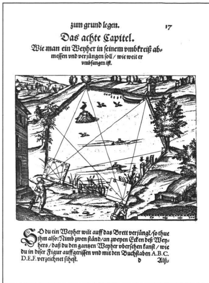
Abb. 3: Messtischaufnahme nach Zubler mit Originaltext (1625) (Bestand: Bibliothek des Förderkreises Vermessungstechnisches Museum, Dortmund).
