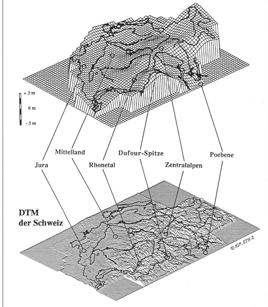
Das gravimetrische Geoid der Schweiz (Geiger, 1990) lässt erkennen, wie die Oberfläche eines *helvetischen Ozeans* aussähe, wenn die Weltmeere durch Kanäle miteinander verbunden wären (Perspektive von SW nach NO). Deutlich erkennbar ist die Anhebung des Geoids im Alpenbereich und die Absenkung in den grossen Tälern, im Mittelland und in der Poebene.
