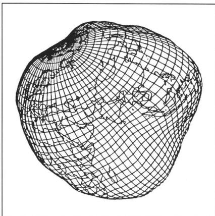
Abb. 1: Geoid (Verformungen 15 000-fach vergrößert): Gitterdarstellung.
