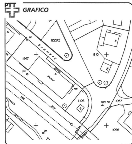
Abb. 4: Grundbuchplan als Basis für Werkleitungsplan PTT.
