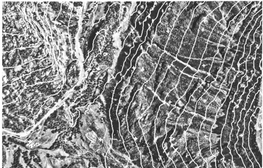
Abb. 8: Digitales Orthophoto mit integrierten Höhenlinien (Gebiet Simplan).
