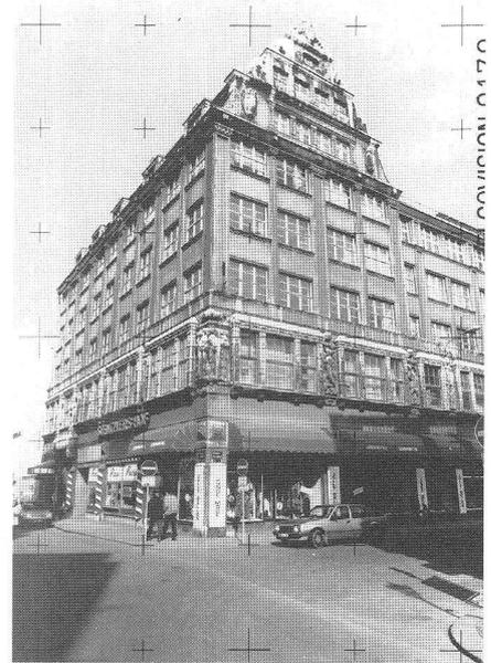
puis 2 points de prise de vue différents. Une ou plusieurs distances connues dans l'objet permettent la mise à l'échelle du modèle. Les points identiques sont digitalisés dans les photos disposées sur une tablette à numériser.
