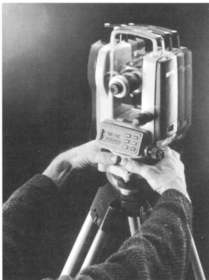
Leica T100 – Elektronischer Bautheodolit.
