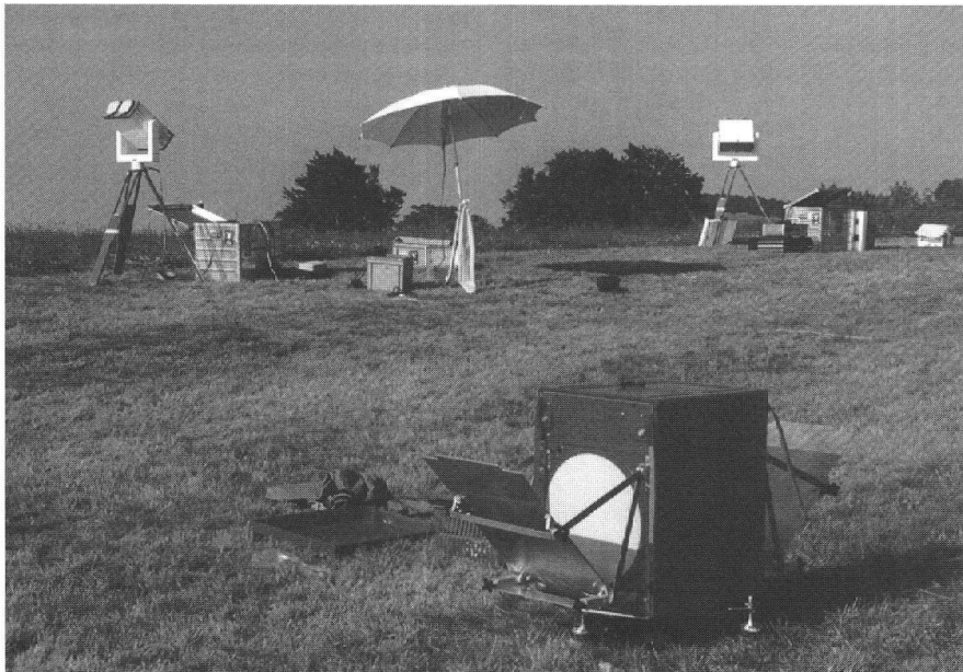
Abb. 9: Die beiden IGP-Radiometer und der Radar-Transponder (im Vordergrund) der Universität Graz (A) in Bauma (Zürcher Oberland) im Einsatz für ein ERS-1 Experiment.
