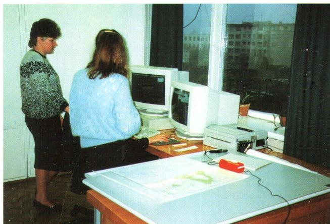
Abb. 4: Intergraph TD-1 Workstation mit Calcomp Digitalisiertisch.
