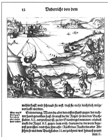
Abb. 4: Distanzbestimmung mit Hilfe des Zublerschen Halbkreisinstrumentes mit zwei Alhidaden (1607) für das Schiessen der Artillerie.
