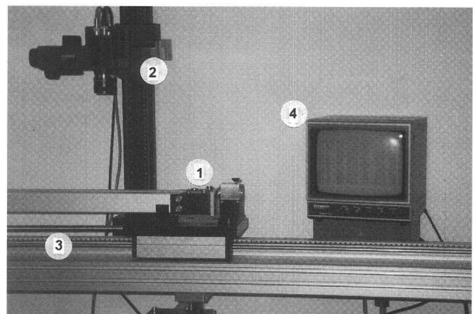
Abb. 10: Kalibrierung von Invarband-Nivellierlatten: 1 Lage- und Befestigung des Prüflings am ersten Laufwagen, 2 Kamerahalterung mit CCD-Kamera, 3 Kupplungsstange zum zweiten Laufwagen, 4 Kontrollmonitor.
