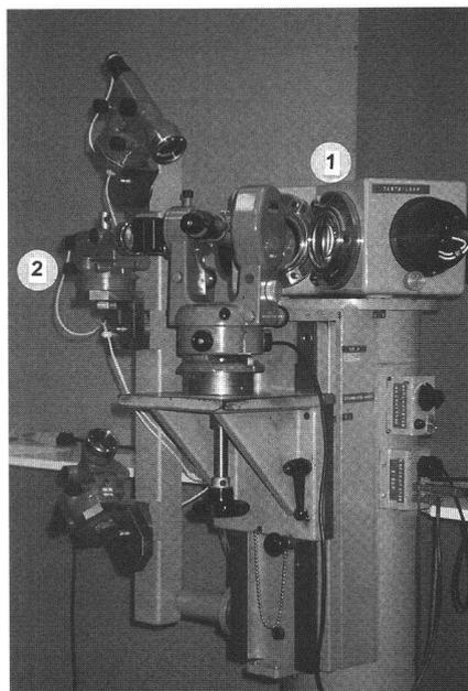
Abb. 1: Kollimator-Prüfplatz für Theodolite nach Kneissl: 1 Winkelkollimator, 2 Kollimator-Vertikalschnitt.
