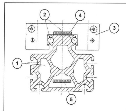
Abb. 5: Querschnitt durch das Linearmodul MLF: 1 Aluminium-Tragschiene, 2 Führungswellen (Stahl), 3 Laufwagen mit 4 Laufrollen, 5 Zahnriemenrückführung.
