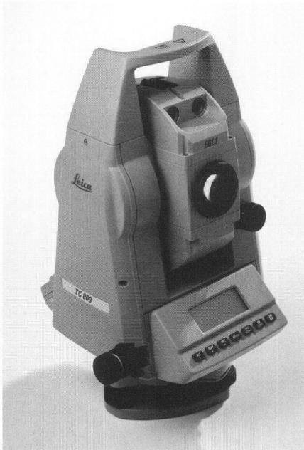
Der neue Leica TC800 Tachymeter mit einer Winkelmessgenauigkeit von 1 mgon (3') und einer Reichweite von 2500 Metern ist für Anwender prädestiniert, die ein einfaches, zuverlässiges und unkompliziertes Vermessungsinstrument zur Lösung von Aufgaben in der Kataster- und Ingenieurvermessung suchen.
