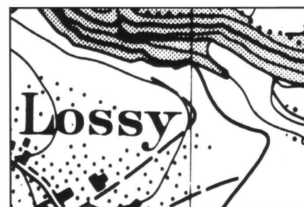
Abb. 4, oben: Ausschnitt aus der Landeskarte 1: 25 000, totales Bild; links mit hoher Auflösung gescannt und gedruckt, rechts als 1:1-Abbildung auf dem Bildschirm simuliert, wo das Bild in bröselige Pixelstruktur zerfällt.
