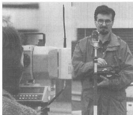
Anwendungsbeispiel: Totalstation-Vermessungspunkt (Detail).
