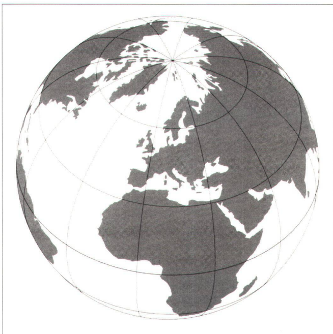
Abb. 4: Orthographische Abbildung (Parallelprojektion) mit einer Zentrierung auf Punkt b_0 = 45^\circ und l_0 = 10^\circ . Bei dieser Abbildung liegt der Betrachtungspunkt im Unendlichen. Es kann nur die Hälfte der Erde dargestellt werden.
