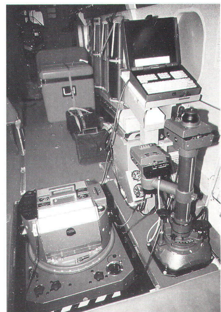
Leica RC30 mit ASCOT installiert im Vermessungsflugzeug «Twin Otter».
