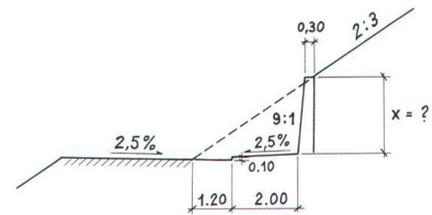
Eine Strasse wird bergwärts verbreitert. Wie hoch muss die Stützmauer beim dargestellten Profil mindestens sein, damit die vorhandene Böschung erhalten bleibt?
