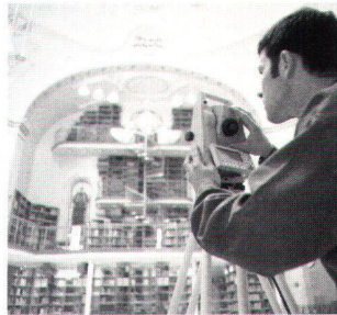
Fig. 3: Mesures en intérieur d'une bibliothèque avec le TCRA. Sa technique de mesure sans réflecteur avec le marquage visible du point visé offre des avantages certains et augmente la productivité.
