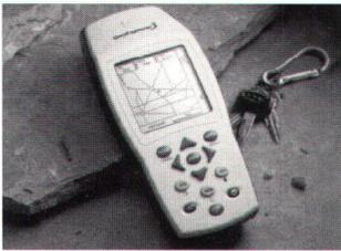
reicht für 32 000 Positionen. Zusätzlich verfügt der Geoexplorer 3 über einen integrierten digitalen Kompass. Dank dieses Hilfsmittels wird das Aufsuchen von Punkten im Feld zu einem reinen Vergnügen. Die im Feld aufgesuchten und dargestellten GIS-Daten können online, mit direktem Blick auf den Bildschirm und die tatsächlichen Gegebenheiten editiert und abgespeichert werden.
