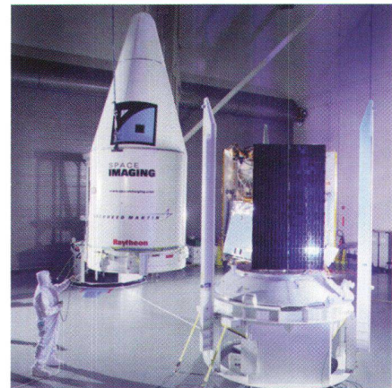
Abb. 1: IKONOS: Der Satellit während den Startvorbereitungen, die Nutzlastverkleidung wird über den Satelliten geschoben (Photo: Lockheed Martin).
