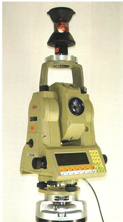
Abb. 4: Montierung des Reflektors.
