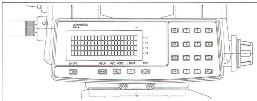
Abb. 3: Bedienungsterminal TR10 (Ausschnitt aus einer Konstruktionszeichnung).
