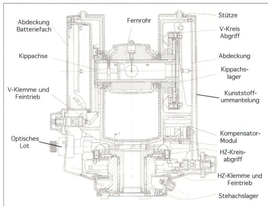
Abb. 2: Schnitt durch den «E10».
