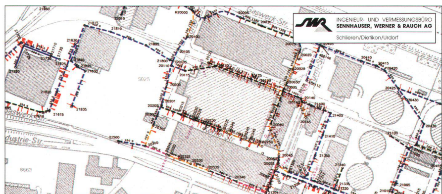
Abb. 4: Abwasser-Zustandsplan (z.v.g. von Sennhauser, Werner & Rauch AG).
