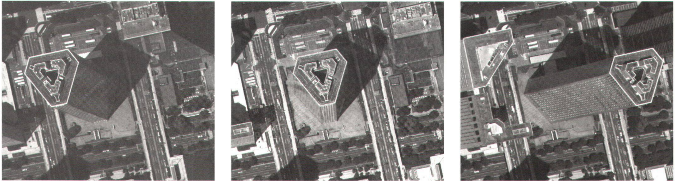
Fig. 4: Shinjuku, Tokyo, Japon. Images panchromatiques arrière, nadir et avant. H = 2000 m s/sol, GSD = 20 cm. Images totales 12\text{ K} \times 53\text{ K} , 25.4 km 2 ; extraits 1120 \times 1320 , 5.9 ha.
