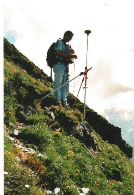
Fig. 3: Implantation et relevé d'un point de la limite cantonale à l'aide de GPS-RTK.
