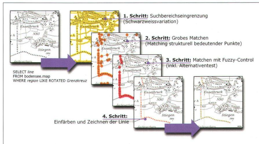
Abb. 7: Prozessschritte bei der geometrisch-semantischen Abfrage: Bildeingrenzung auf Grund der Farbwerte, Matching charakteristischer Bestandteile, fuzzifiziertes Matching mit Alternativentest, Ausgabe des Resultats als überlagertes DXF-Linienfile.
