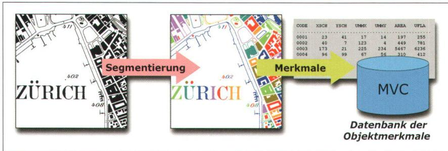
Abb. 4: Segmentierung und Berechnung von Objektmerkmalen.
