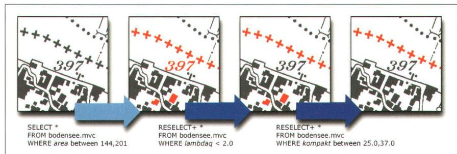
Abb. 5: Objektmerkmalsbasierte Abfrage für die Grenzlinie: Die hintereinander ausgeführten Abfragen nach den Merkmale Fläche (area), Hauptachsenverhältnis (lambda) und Kompaktheit (kompakt) führen zur sukzessiven Eingrenzung des Resultats.
