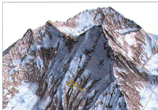
Abb. 5 und 6: Links: DTM mit eingefärbten Höhenstufen und synthetischer Reliefschumierung. Rechts: DTM mit überlagert Karte 1:50 000. Im Zentrum Mount Everest (8850 müM), links Lhotse (8501), im Hintergrund Nuptse (7861).
