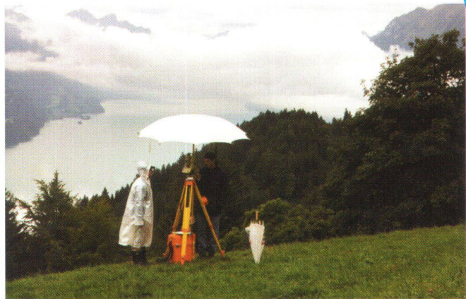
Abb. 2: Impressionen 2: Hoch über dem Brienzsee – Deformationsmessungen FHBB.
