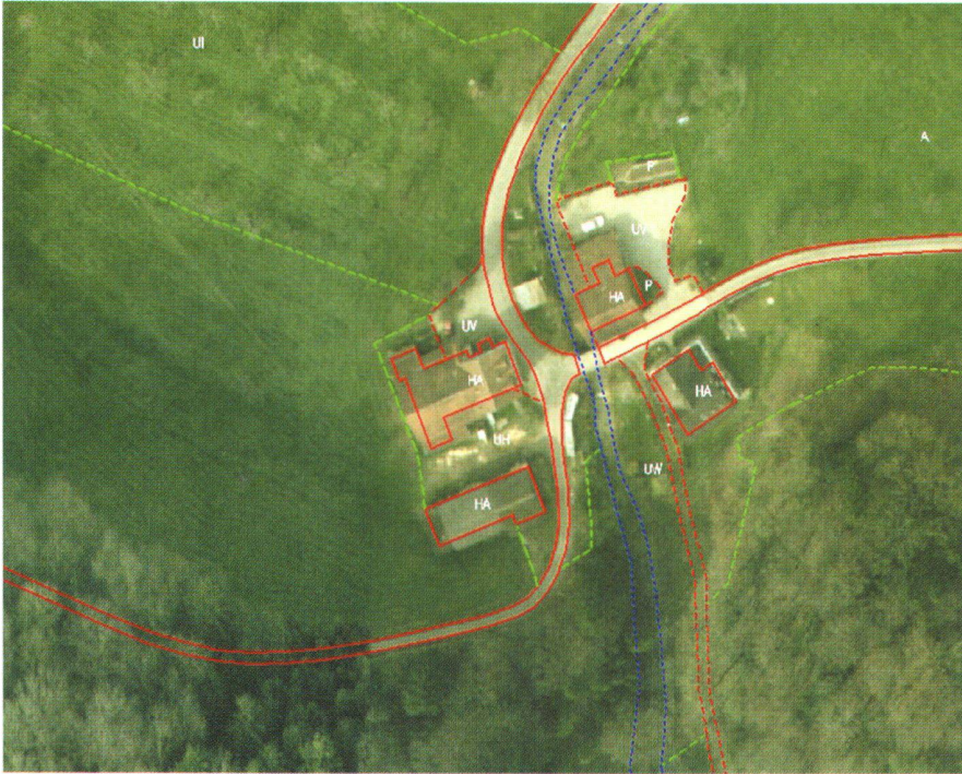
Abb. 2: Das Orthophoto wurde aus zwei Bildern gerechnet. Die Schnittlinie der beiden Bilder läuft vertikal durch die Bildmitte und ist am Waldrand zu erkennen – links Bäume, die nach «oben kippen»; rechts Bäume, die «senkrecht stehen». Die Überlagerung mit der photogrammetrischen Auswertung zeigt am Waldrand und an der Gewässerlinie deutlich die Limitierung, die beim Digitalisieren aus Orthophotos entsteht.
