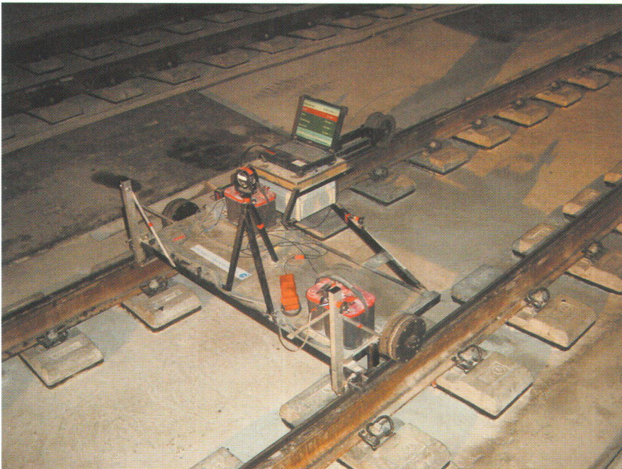
Abb. 5: Der Burgdorfer Gleismesswagen.
