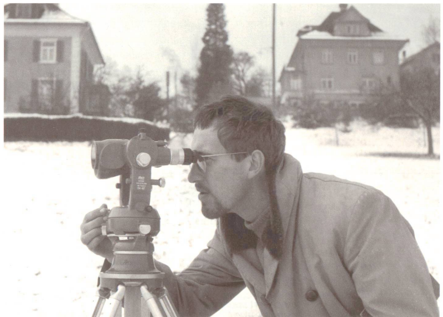
Abb. 5: Anfang der 60er-Jahre erfolgte mit der Markteinführung des KERN DK-RT (Doppelkreisreduktions-Tachymeter) ein echter Quantensprung in der Messtechnik. Hohe Genauigkeit, komfortable Handhabung und speditives Arbeiten waren die hervorstechenden Eigenschaften dieses Gerätes, welches bis zur Verbreitung der elektronischen Distanzmesser den Markt beherrschte.
