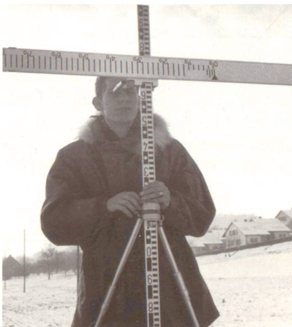
Abb. 4: Auf dieser Aluminium-Messlatte wurden die ganzen Meter der Horizontalabstände direkt abgelesen. Die cm-Einheiten erschienen nach dem Koinzidieren der verschobenen Lattenbilder direkt auf einer Mikrometertrommel neben dem Fernrohrokular. Geübte Vermesser erzielten mit diesem Gerät spielend eine Genauigkeit von \pm 1 \text{ cm}/100 \text{ m} .
