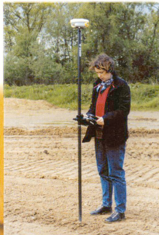
Verwendung eines GPS-Rovers zur Baustellenermessung und Neigungs- und Höhenkontrolle.
