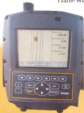
Das Display im Führerhaus zeigt die Schildposition im Verhältnis zum Entwurf an.
