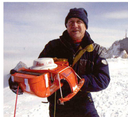
Bald auf Mt. Everest und K2: Professor Giorgio Poretti mit seinem schneegängigen GPS-Georadargerät zur Messung der Schnee- und Eisdecke. Hier beim Prototypen-Test im März dieses Jahres auf dem Marmoladagletscher. Foto: Ev-K2-CNR/Leica Geosystems.
