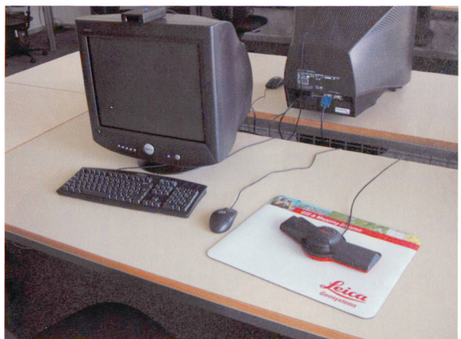
Photogrammetrie WS mit Leica Geosystems TopoMouse.
