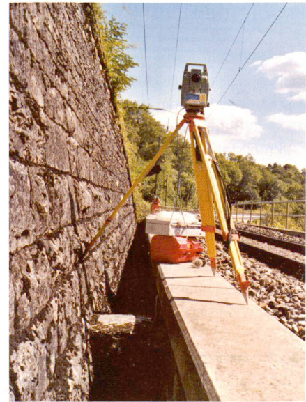
Abb. 2: Unkonventionelle Station unter Einhaltung des Sicherheitsabstandes zum Betriebsgleis.
