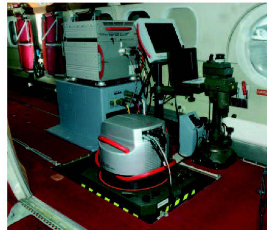
Abb. 1: ADS40 im TwinOtter vor dem Start zum Bildflug.
