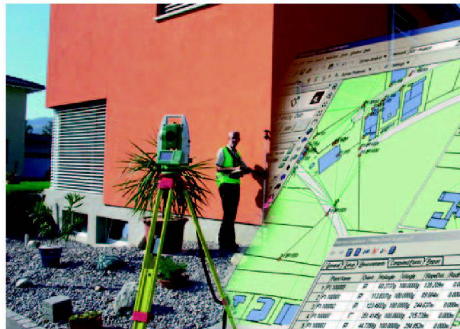
Einmannstation mit MobileMatriX via Funk am Reflektor.
