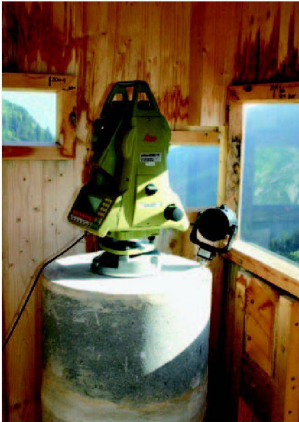
Abb. 3: Tachymeter auf doppelwandigem Pfeiler in Schutzhaus.
