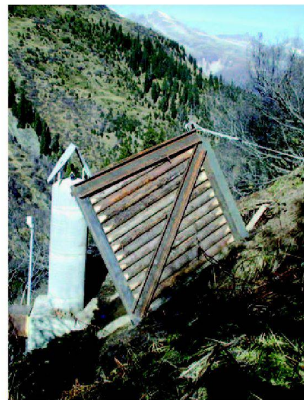
Abb. 6: Beobachtungspunkt mit Me-teo-Sensor und Schutzvorrichtung gegen Kriechschnee.
