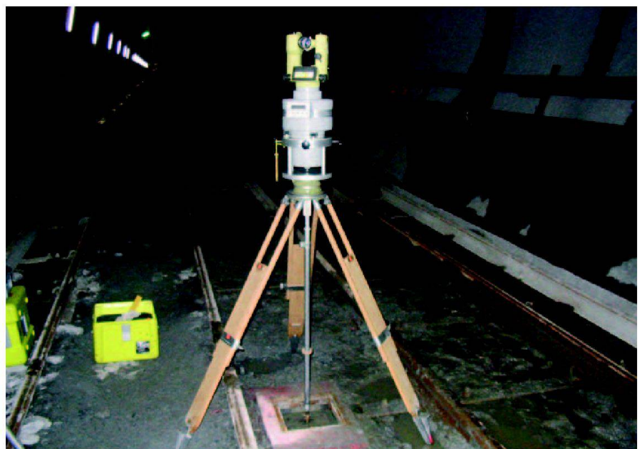
Abb. 3: Präzisionsvermessungskreisell Gyromat 2000 im Einsatz in Bodio.
