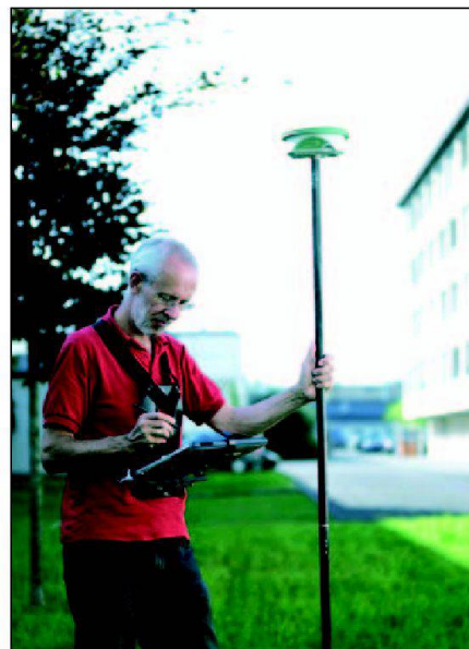
Abb. 1: MobileMatriX mit kabelloser Bluetooth-Verbindung zum GPS-Rover.
