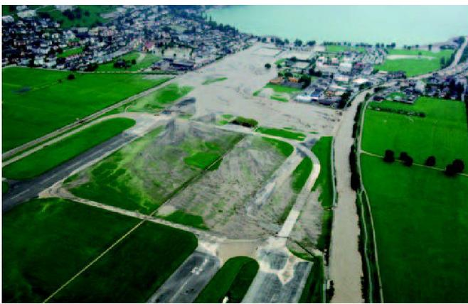
Abb. 1: Die Engelberger Aa in der Ebene zwischen Ennetbürgen und Buochs während des Hochwassers Ende August 2005. Gut zu sehen sind die Entlastungsstellen, an denen das Hochwasser kontrolliert die Ebene überfluten kann (© Schweizer Luftwaffe).
