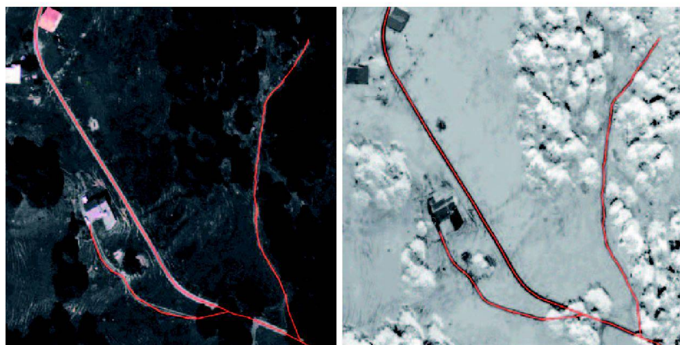
Fig. 4: Zones traitée à l'aide d'Easytrace, l'information vectorielle est en rouge (à g. RGB, à d. prétraitée NDRI).
