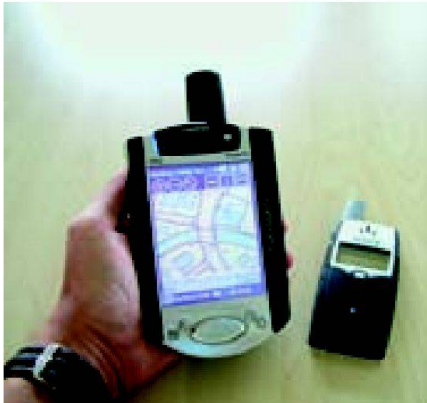
Abb. 2: GeoShop Mobile Client mit GPS-Unterstützung.
