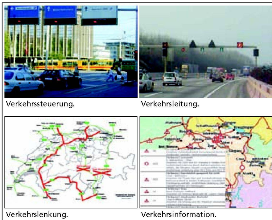
Abb. 1: Die vier Komponenten des Verkehrsmanagements: Steuern – Leiten – Lenken – Informieren.
