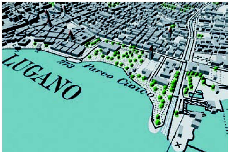
Abb. 4: Lugano (TI). Perspektive aus der Pixelkarte 1:25 000 und DHM25, Einzelbäume, Gebäude und Kirchtürme automatisch in der Pixelkarte identifiziert (M. Zanini).
