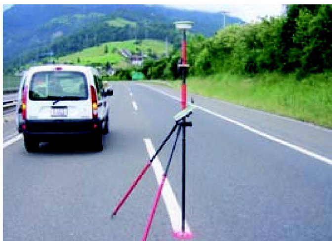
Abb. 4: Passpunktmessung mittels GPS.
