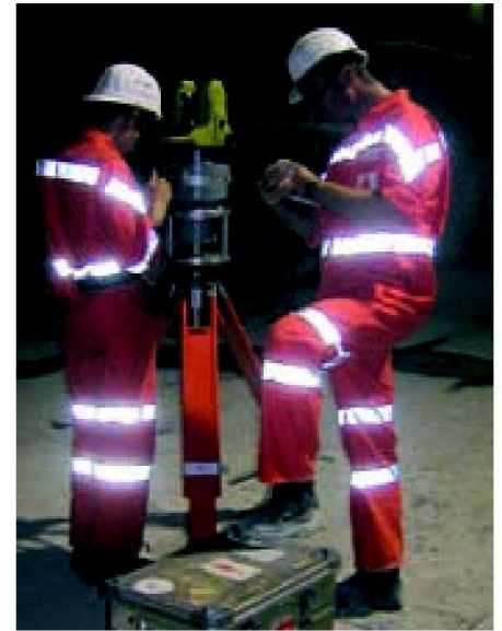
Abb. 5: Kreismessungen mit dem Gyromat 2000, Version UniBwM (Drahtlose Steuerung, Datenübertragung und Auswertung über PDA).
