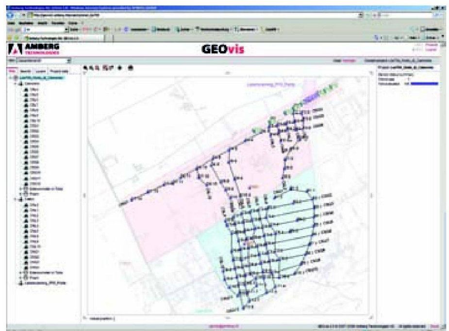
Abb. 3: GEOvis: Mit dem Webinterface GEOvis können die Messdaten jederzeit interaktiv abgefragt werden.
