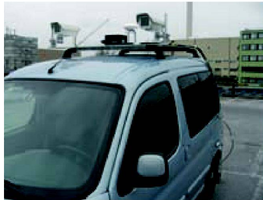
Abb. 2: Forschungsplattform Mobile-Mapping-IVGI mit Inertialmesseinheit (schwarzer Kubus), GPS-Antenne und Stereo-Bildsensoren.
