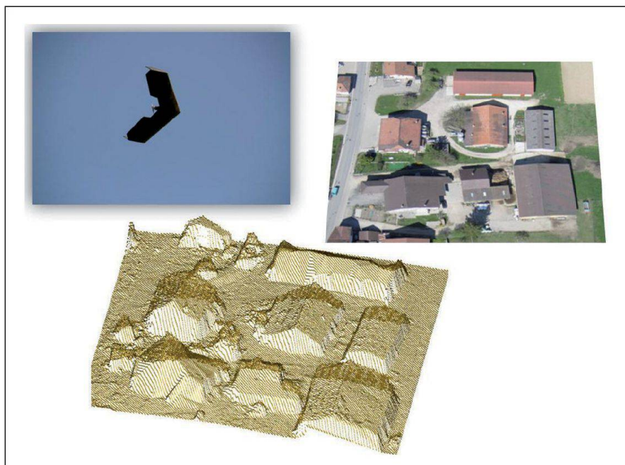
Fig. 5: Drone «R-Pod», Orthophoto à 10 cm (à droite), MNS brut à 10 cm (en bas).
